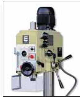
Volante frontal para avance sensitivo fino Frontal wheel for fine sensitive feed Volant frontal pour avance sensitif fine Vorderes handrad für den vorschub bei feinarbeitungen und plandrehen
